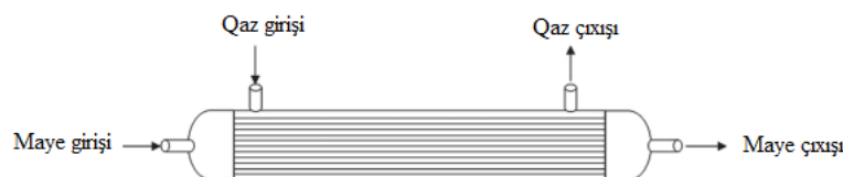
Şəkil 2. Paralel axınlı içi boş lifli qaz-maye membran kontaktoru
